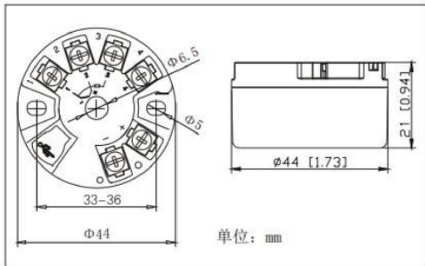
图 2 温度模块尺寸图
