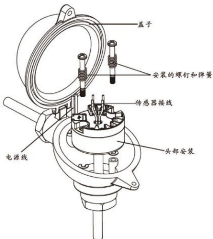
图 1 温度模块总装图
